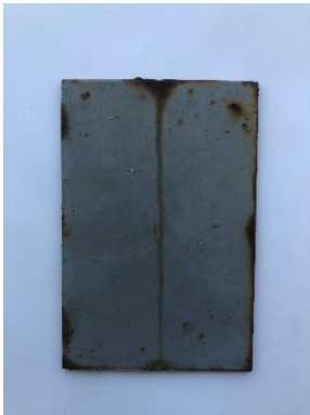
Grátt – 1 Bakhlið Ri 1 Einn ryðblettur í hæggra horninu
