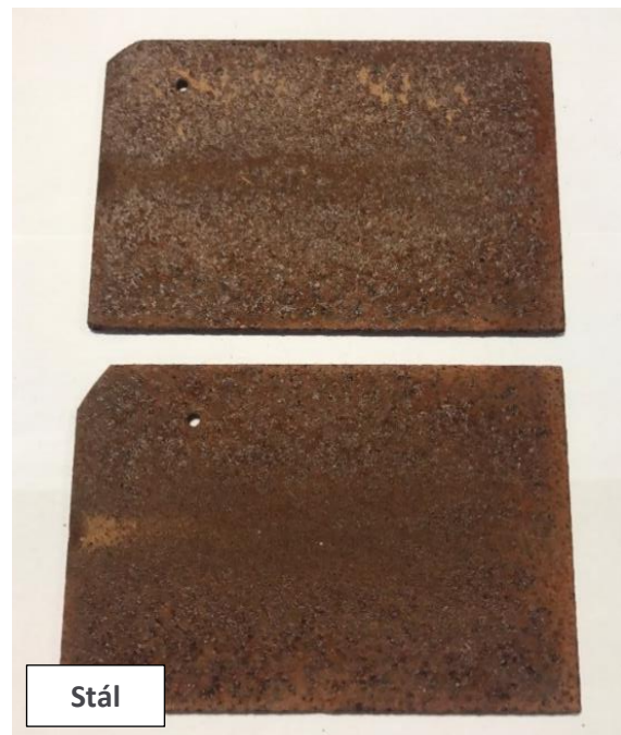
MYND 6 Tæringarsýni frá Bolungarvík. Efri röðin sýnir álsýni en sú neðri stálsýni, heitgalvanhúðað vinstra megin.
