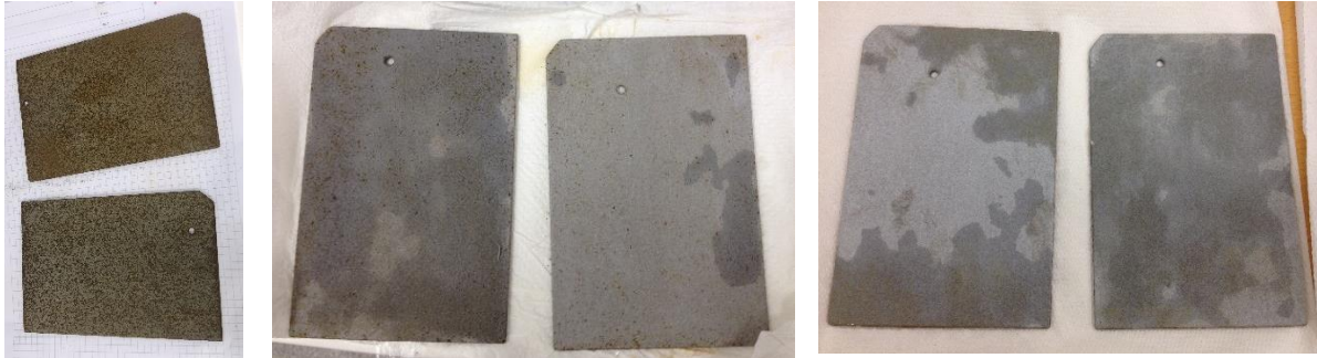
MYND 9 Slálsýni eftir 1., 2. og 3. þvott.
