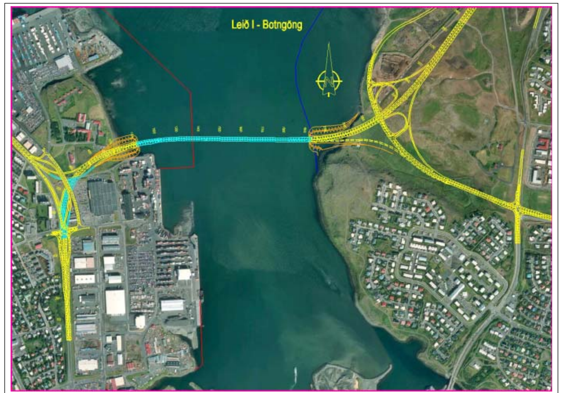
Mynd 5.1 Grunnmynd af legu botnganga undir Kleppsvík
