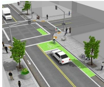
Mynd 5 Útfærsla 2, gatnamót með umferðarljósum. Umferð hjólandi færð nær akandi með hjólarein a.m.k. 20-30 m áður en komið er að gatnamótum ( www.ebbc.org ).
