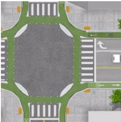
Mynd 4 Útfærsla 1, gatnamót með umferðarljósum. Umferð hjólandi aðskilinn frá umferð akandi ( www.knoxgardner.com/ ).
