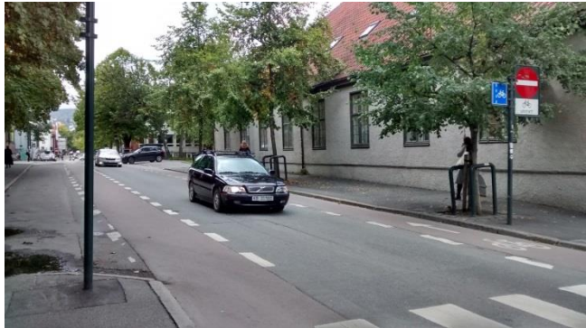
Mynd 19 Hjólað á móti einstefnu í Prándheimi. Sérstakar hjólareinar afmarkaðar.
