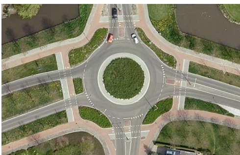
Mynd 6 Útfærsla 3, hringtorg. Umferð hjólandi aðskiling frá umferð akandi. ( http://bicycledutch.wordpress.com/ ).
