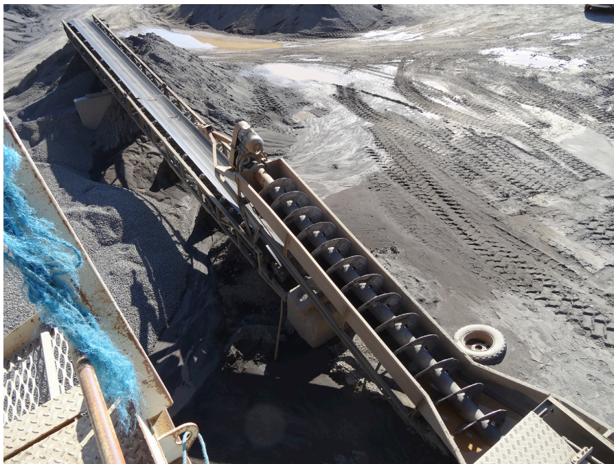
Þvottasnegill fyrir sand (HEJ).
