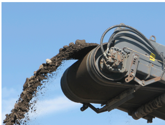
Aðskilnaður efnis á sér stað á færíbandi. Grófara efnið kastast lengra en fínna efnið fellur beint niður (HEI).
