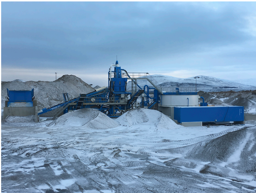
M2500 E4 þvottastöð frá írsku fyrirtækinu CDE Global uppsett í Hólalbrú Hvalfirði (HEJ).
