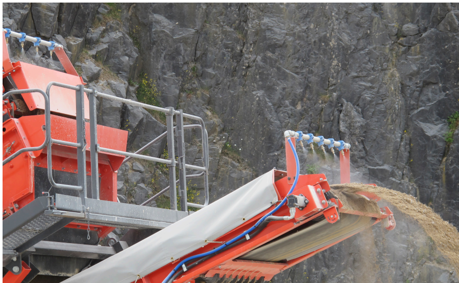
Sandvik QA331 tveggja hæða hallandi hristiharpa. Við enda hvers færibands eru úðastútar sem úða vatni til að dempa ryk (HEI).
