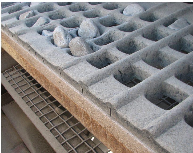
Þykkt gúmmínet (hlífðarmotta) efst. Þar undir er flokkunarnet sem er ofið vírnet (HEJ).
