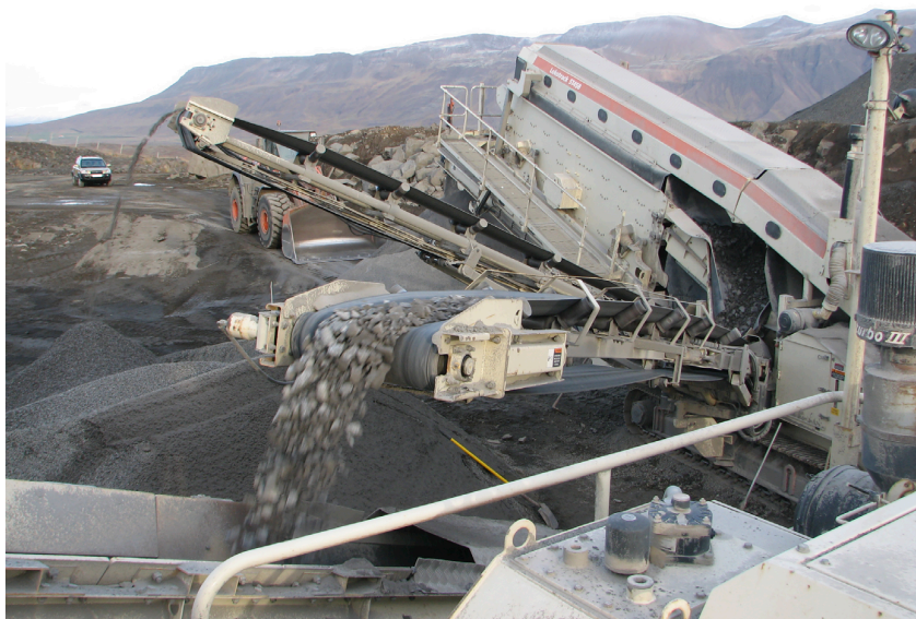
Hristiharpa. Lokotrack ST458 með 3 hæðum og 4 færíböndum. Uppsáir í Húnavatnssýslu (HEJ).
