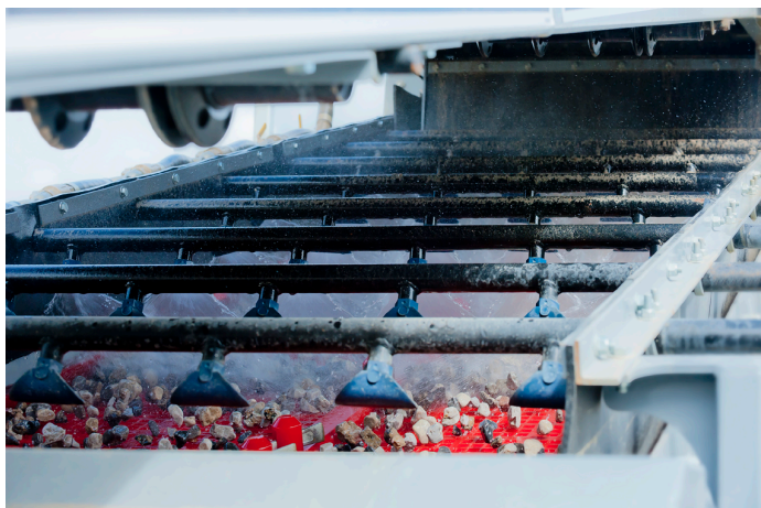
Lokotrack ST4.8 frá Metso. Á hverju röri eru 7 úðastútar. Stútarnir breikka út. Með góðum vatnsbrýstingi verður bunan breiðari. © Metso.
