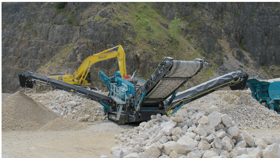
Tveggja hæða Warrior 2100 grjótharpa frá Powerscreen með þremur færiföndum (HEJ).
