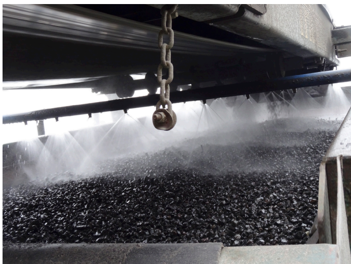
Trident Erin TD125T – tveggja hæða harpa. Heimagerð þvottagrind. Fjögur rör á hverri hæð 1,5 m löng með 8 spissa (úðastútum) á hverju röri (HEJ).
