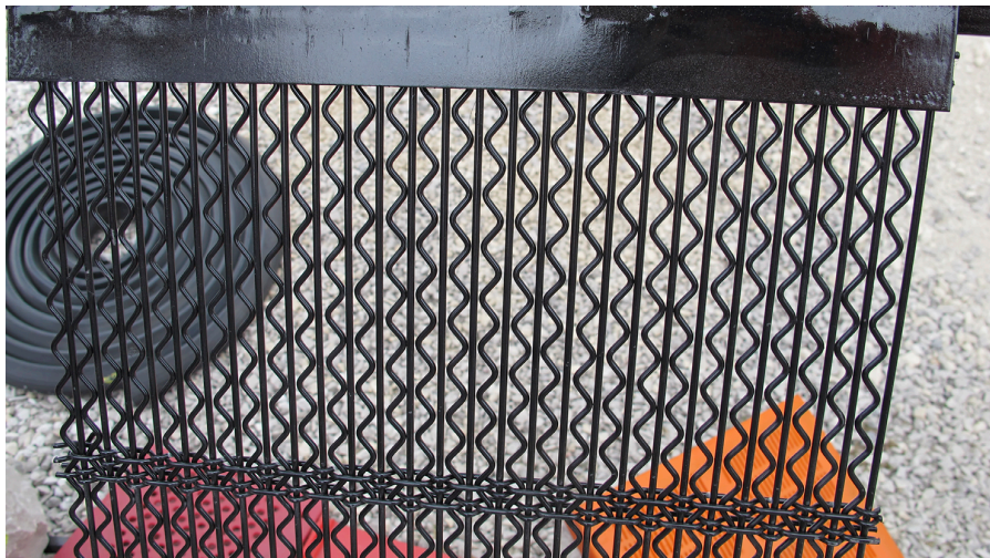
Sjálfhreinsandi net. Stundum kallað sikk-sakk net (HEJ).
