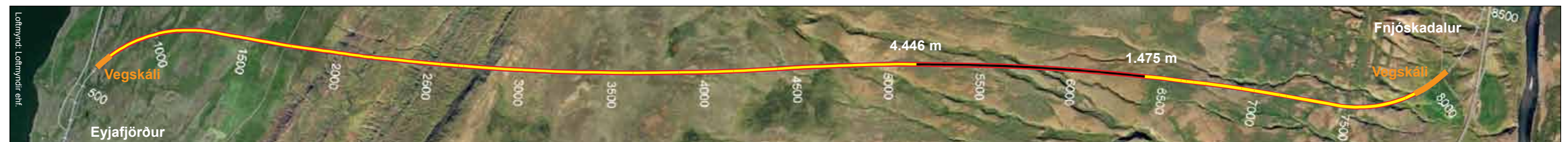
Vaðlaheiðargöng, staða framkvæmda 12. september 2016. Búið er að sprengja samtals 5.920 m sem er 82,2% af heildarlengd.
