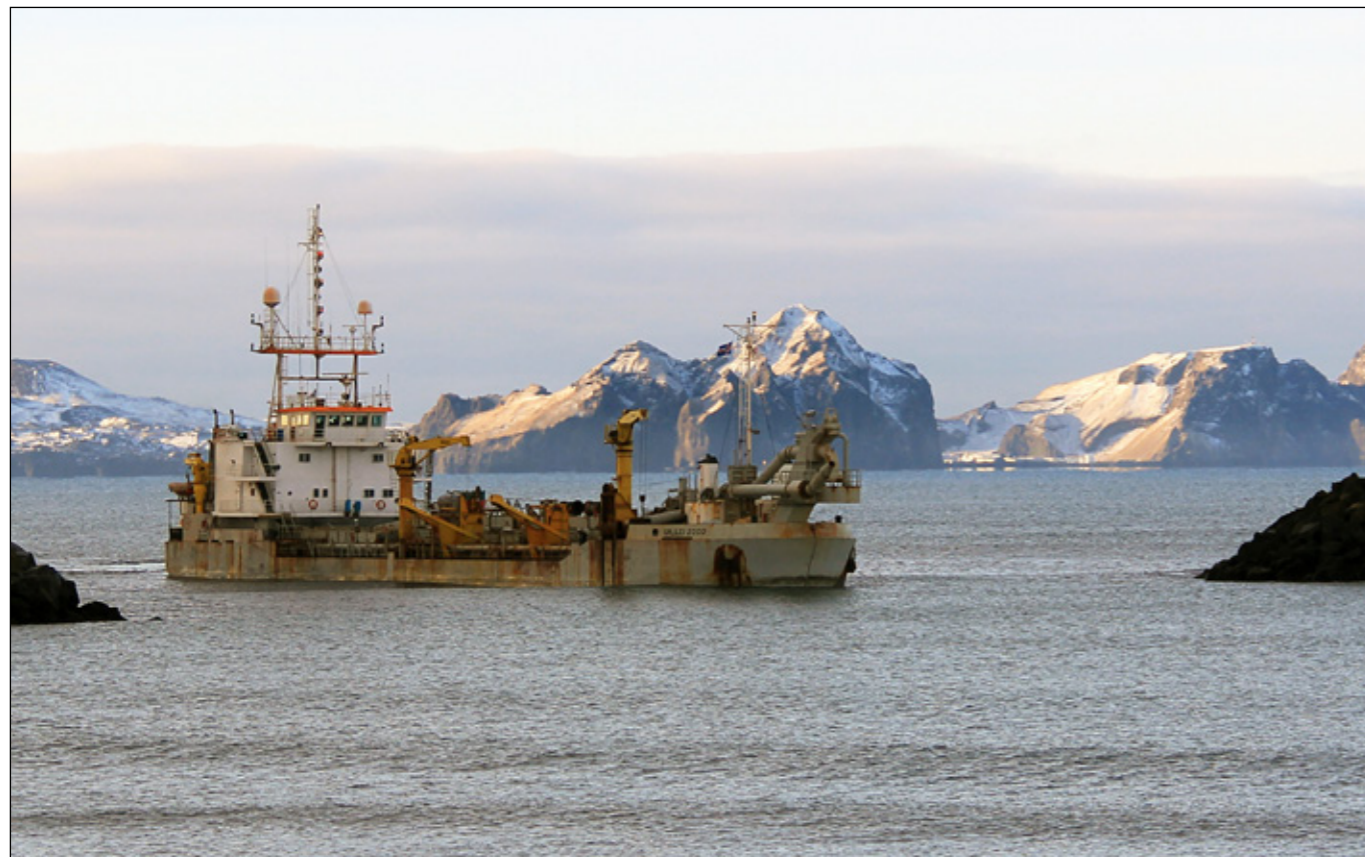
Dýpkunarskipið Galilei 2000, sem er í eigu belgíska fyrirtækisins Jan De Nul, er við dýpkun í Landeyjahöfn og er gert ráð fyrir því að það verði hér fram í vor þar sem það mun dýpka um 350.000 m 3 . Skipið er byggt 1979 og er með 2.320 m 3 lest, ristir 3,3 m og er 84 m langt. Það tæmir sig með því að opna sig (e. split barge), en þau dæluskip sem hafa unnið í höfninni eru ekki með þennan búnað, og því eru afköst skipsins mun betri en þegar dæla þarf efni úr skipinu eins og tíðkast á hinum skipunum. Áður en skipið kom til Íslands var það við störf við strendur Brasilíu. Mynd: Ingvar Hreinsson. Vestmannaeyjar í baksýn.
