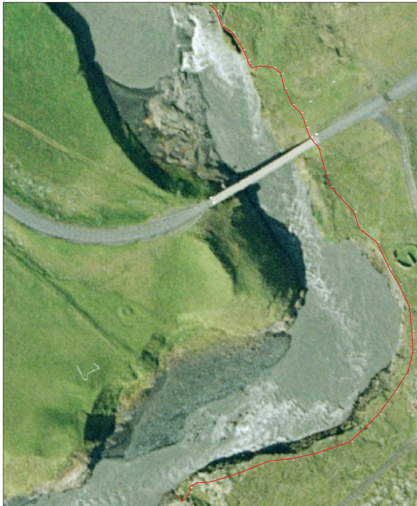
Eldvatn hjá Ásum. Rauða línan sýnir mældan austurbakkann eftir hlaupið og gefur þetta góða mynd af rofinu.
