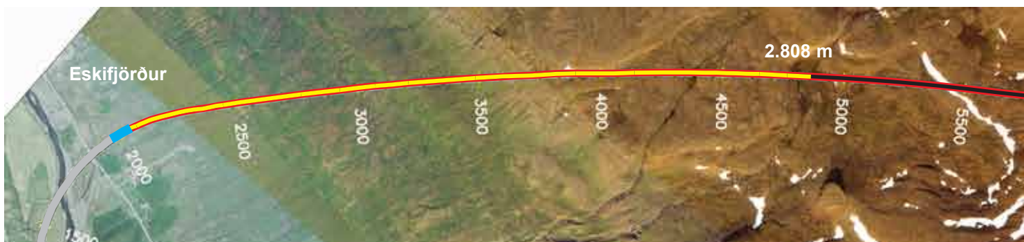
Norðfjarðargöng, staða framkvæmda fyrir jólafrí 24. janúar 2015. Búið er að sprengja samtals 5.138 m sem er 67,9% af heildarlengd.
