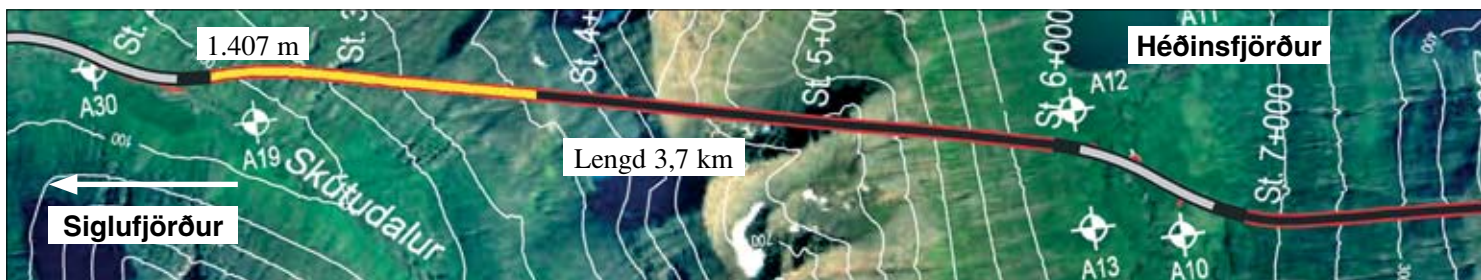
Staða framkvæmda við Hédinsfjarðargöng 22. apríl 2007. Búið er að sprengja 1.407 m í Siglufirði og 1.160 m í Ólafsfirði.
