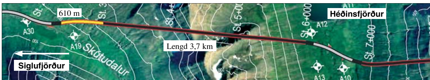
Staða framkvæmda við Héðinsfjarðargöng 8. janúar 2007.
