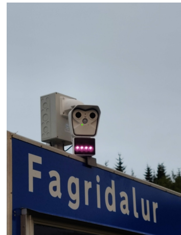
Mynd 4: Greiningarbúnaður festur á vindmælingarskilti. Staðsetning - Snið 3.
