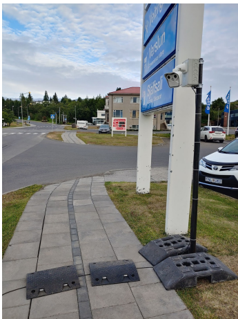
Mynd 2: Greiningarbúnaður festur á sérsníðaðan staur. Staðsetning - Snið 8b.
