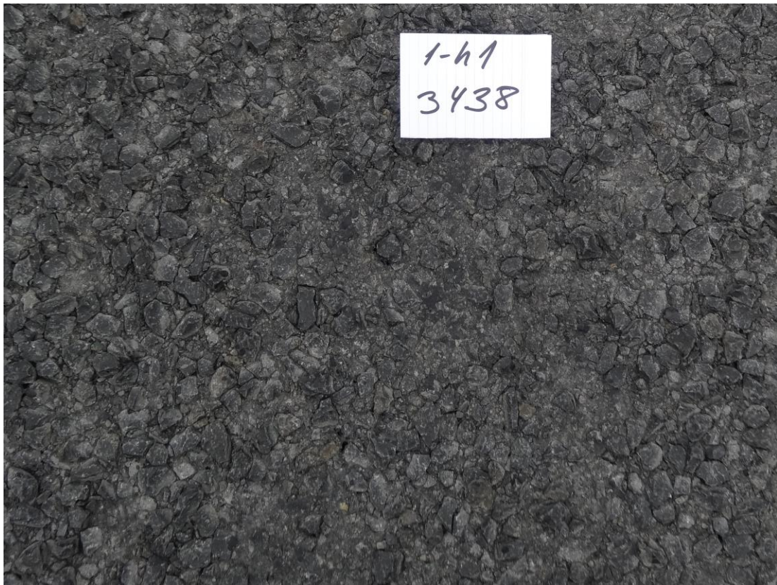
Mynd 24 Bikþeyta með R11 emulgator og SBS 2% 2016
