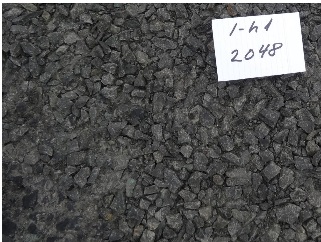
Mynd 12 Bikþeyta með TNB emulgator og án SBS
