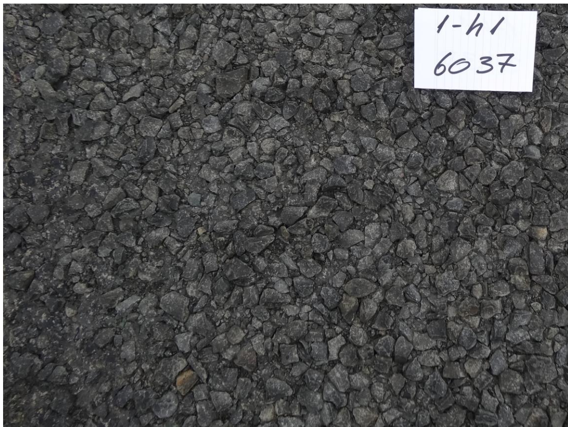
Mynd 30 Þjálbik/þunnbik með 3% etylester og 3% steinolú 2016
