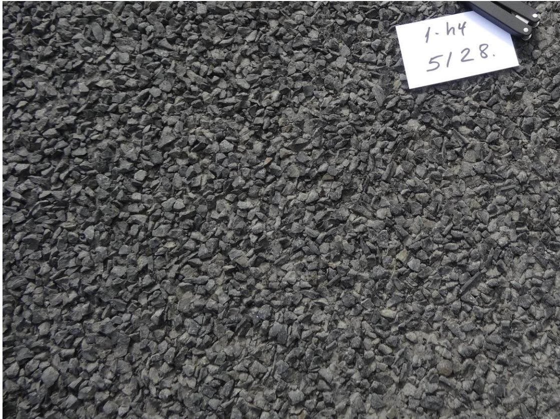
Mynd 51 Bikþeyta með TNB emulgator og með SBS 2016
