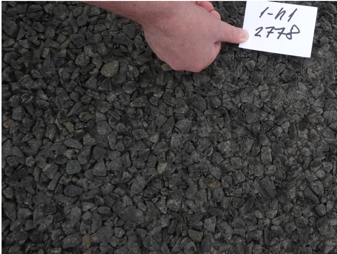
Mynd 18 Bikþeyta með R11 emulgator og bikþeytan með latex (SBR 2%) 2016
