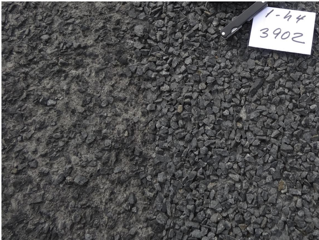
Mynd 39 Þjálbik/þunnbik með 3% etylester og 3% steinolú 2016
