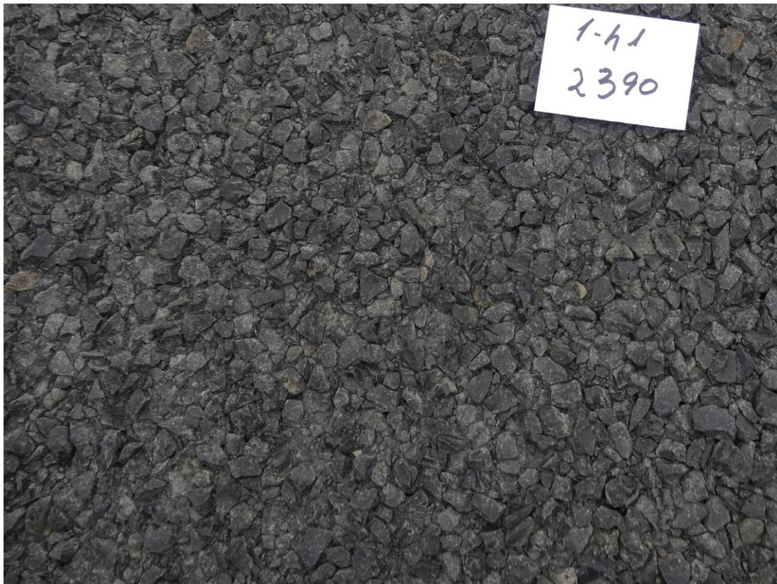
Mynd 15 Bikþeyta með R11 emulgator og bikþeytan án latex 2016
