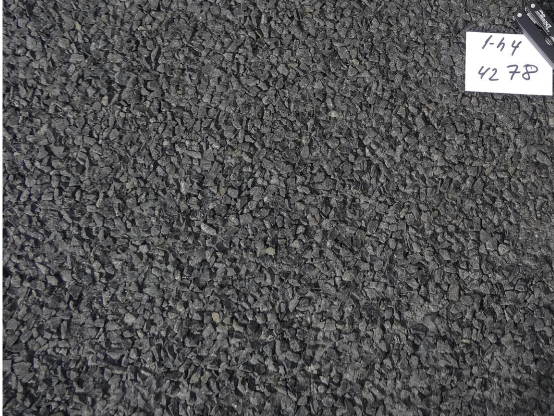
Mynd 42 Bikþeyta með TNB emulgator og án SBS 2016
