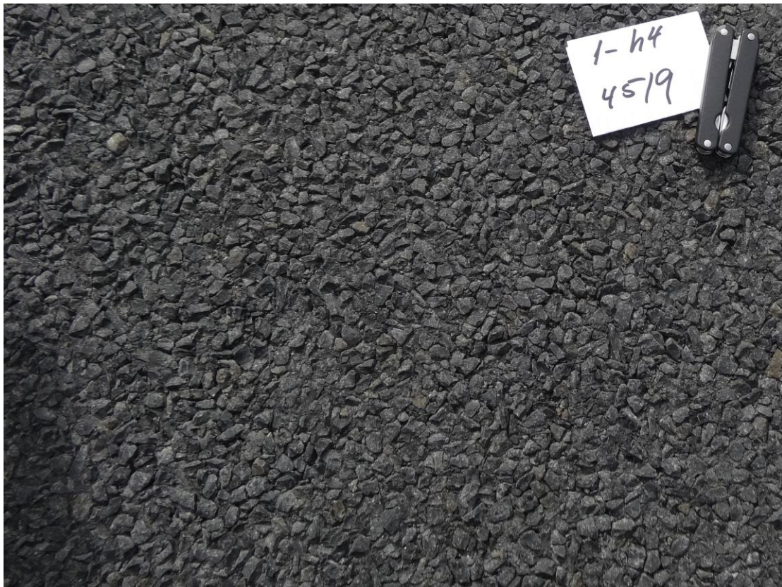
Mynd 45 Bikþeyta með R11 elmugator og án latex 2016
