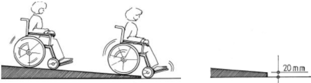
Mynd 2-2 Halli, hæðarmunur og kantar hafa mikil áhrif á hvort leiðir eru færar (Statens vegvesen, 2014b bls. 38)
