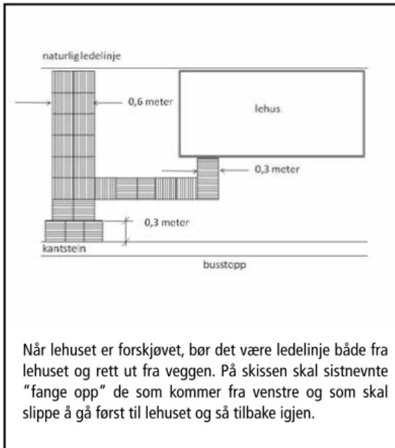
Mynd 5-2: Myndin sýnir tvönn konar útfærslur á leiðarlínum eftir því hvar biðskýli eru staðsett (Statens Vegvesen, 2014 bls. 97)
