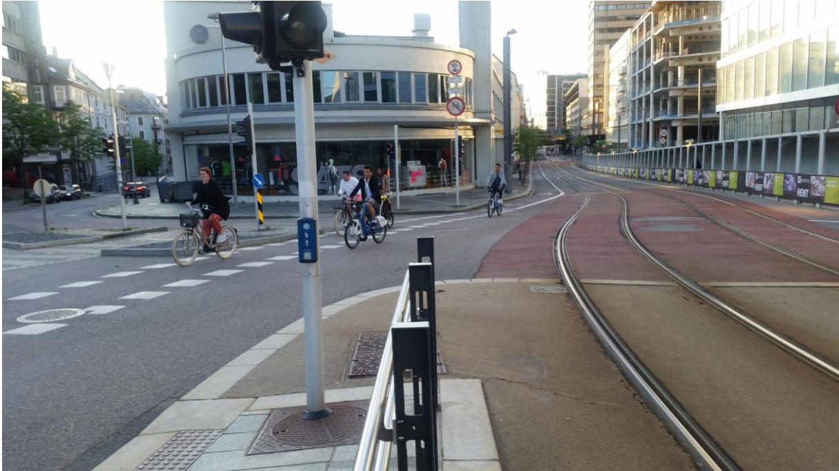
Mynd 6-1 Á myndinni má sjá skilti, biðstöðvarnapp með hljóði, umferðarljós, handlista, leiðarlínur, kanta ásamt máluðum upplýsingum á yfirborð gatna. (Mynd: Áslaug Katrín Aðalsteinsdóttir)
