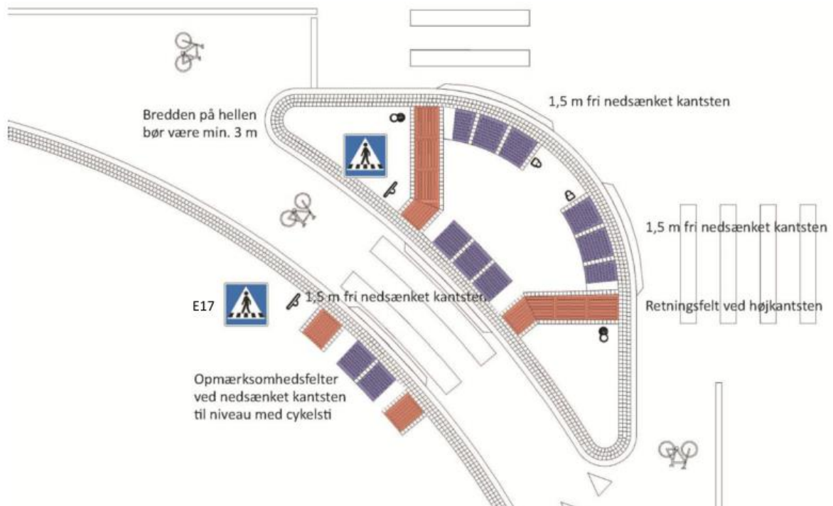
Mynd 4-15 Útfærsla niðurtækta við hjólahjáleiðir (Pedersen et al., 2013, bls. 79)
