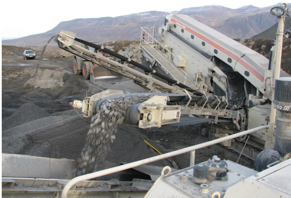
Mynd 3.4.2.4. Hristiharpa. Lokotrack ST458 með 3 hæðum. Hörpunarflötur er 7.9 m 2 . Myndin er tekin í námunni við Uppsali í Húnavatnssýslu (Hafdís Eygló Jónsdóttir 2010).
