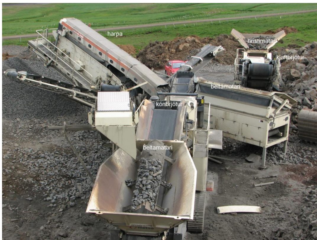
Mynd 3.2.2. Þrjár vinnslueiningar í námu við Leiðólfsstaði í Laxárdal: kjaftbrjótur, harpa og kónbrjótur. Matarar eru við allar einingarnar (Hafðís Eygló Jónsdóttir 2010).
