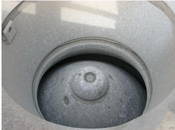
Mynd 3.3.3.5. Topplegulaus kónbrjótur. Séð ofan í brjótinn (Hafdís Eygló Jónsdóttir 2010).
