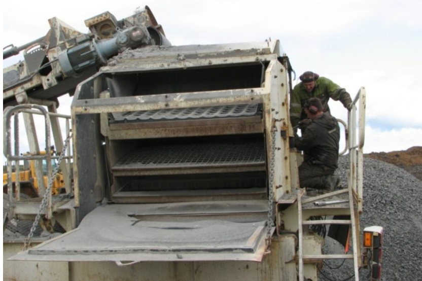
Mynd 3.4.2.2. Hallandi hristiharpa. Skipt um net í hallandi hristihörpu á Nordberg NW300 GPD mólunarsamstæðu Taks. Hörpunarflöturinn er 1,2 m x 2,0 m. Efst er hlífðarsigti úr gúmmí (gerð Skega Panelcord) og svo koma flokkunarnet úr vírneti. Einungis tvær stærðir koma út úr þessari hörpu. Þessar hörpur eru hannaðar til að sigta efni með mjög litlum hörpunarfleti (lítill og stutt). Myndin er tekin í námunni á móts við Bláskriðu á Melrakkaslétu (Hafdís Eygló Jónsdóttir 2010).
