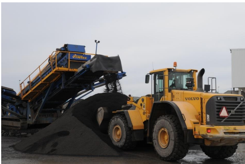
Mynd 3.7.3. Mokað undan færíbandi á FinTec hörpu. Mokað úr sama skóflufarinu. Plastdúkur er settur framan við færíbandið til að tryggja að efnið falli beint niður (Hafdís Eygló Jónsdóttir 2012).
