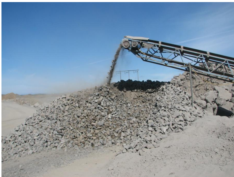
Mynd 3.7.2. Aðskilnaður undir færíbandi. Forbrotið klapparefni úr skeringu á Hólaheiði. Þennan dag var hvasst og má sjá allra fínasta efnið fjúka (Hafdís Eygló Jónsdóttir 2010).
