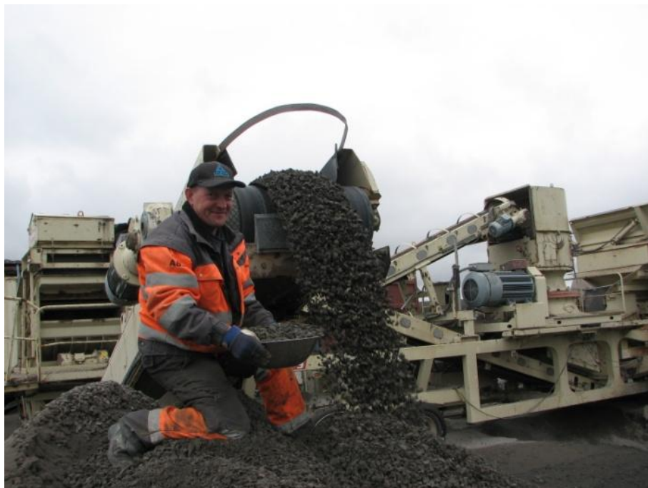
Mynd 4.1.2.1. Sýnataka. Sýni tekið undan færibaldi í klapparnámu á Dettifossvegi. Gunnar M. Sveinbjörnsson vélamaður hjá Skútabergi (Hafðís Eygló Jónsdóttir 2010).
