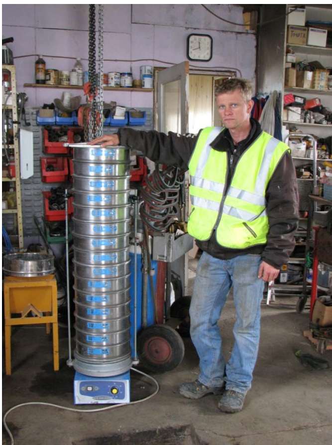
Mynd 4.1.3.2. Sigtaröð með 15 sigtum (blönduð sigtaröð). Grófasta sigtið er 53 mm. Þvermál sigtanna er 300 mm. Sigtin og hristarinn eru frá fyrirtækinu Matest á Ítalíu. Jón Bergur Arason hjá fyrirtækinu Þverá Golf ehf. (Hafdís Eygló Jónsdóttir 2012).
