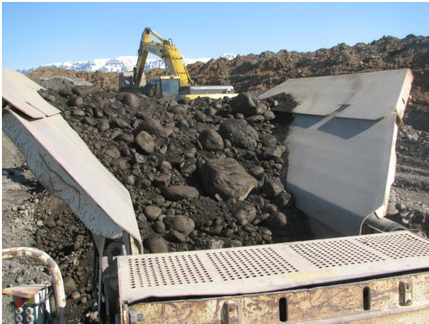
Mynd 5.3.2 Malarefni úr malarhjalla (fornum árhjalla) í matara forbrjóts. Myndin er tekin í Búastaðanámu í Vesturdal í Vopnafirði (Hafdís Eygló Jónsdóttir 2012).
