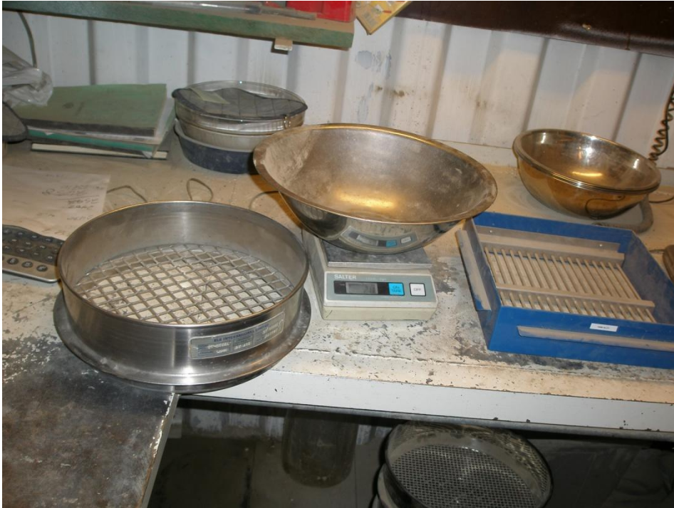
Mynd 4.1.4.1. Hringlaga ferningssigti vinstra megin á mynd og ferkantað stafasigti hægra megin. Myndin er tekin á rannsóknastofu Skútabergrs ehf. á Akureyri (Guðmundur Ragnarsson 2012).
