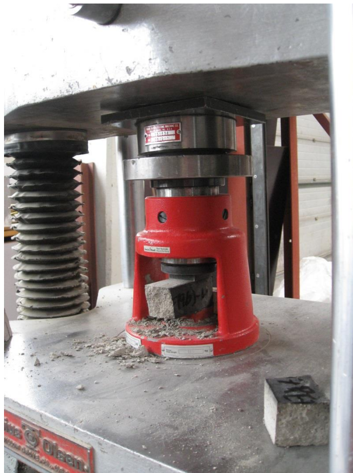
Mynd 4: Tinius Olsen brotþolspressan sem notuð var í verkefninu.
