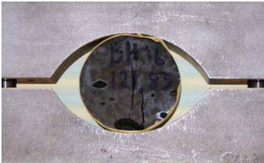
Nr. 44: Tholeiite (vesicular) \sigma_t = 6,57 MPa.
