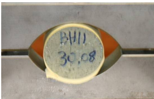
Nr. 96: Rhyolite (homogeneous) \sigma_t = 4,16 MPa.
