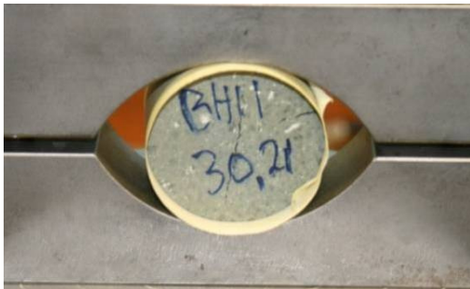
Nr. 86: Rhyolite (homogeneous) \sigma_t = 4,38 MPa.
