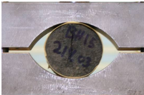
Nr. 46: Altered olivine tholeiite \sigma_t = 8,351 MPa.
