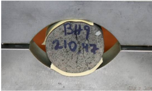
Nr. 50: Altered olivine tholeiite \sigma_t = 2,78 MPa.
