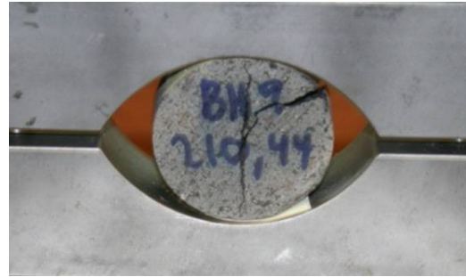
Nr. 51: Altered olivine tholeiite \sigma_t = 5,47 MPa.
