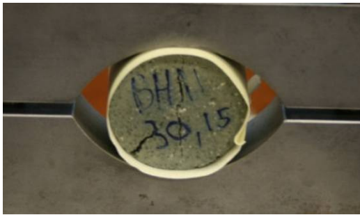
Nr. 84: Rhyolite (homogeneous) \sigma_t = 4,79 MPa.
