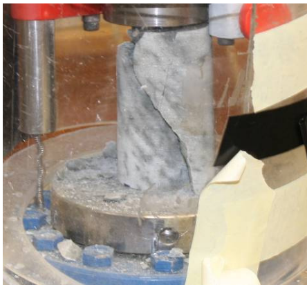
Nr. 22: Rhyolite (homogeneous) \sigma_c = 125,2 MPa.
