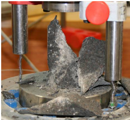
Nr. 14: Altered olivine tholeiite \sigma_c = 78,6 MPa.
