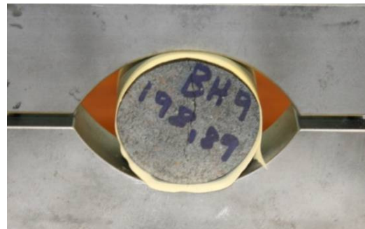
Nr. 69: Altered olivine tholeiite \sigma_t = 6,78 MPa.
