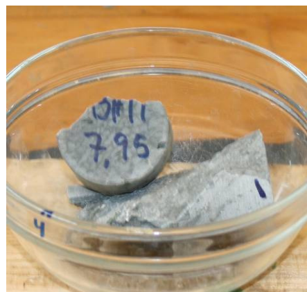
Nr. 35: Rhyolite (homogeneous) \sigma_c = 135,6 MPa.
