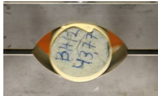
Nr. 79: Rhyolite (inhomogeneous) \sigma_t = 1,56 MPa.
