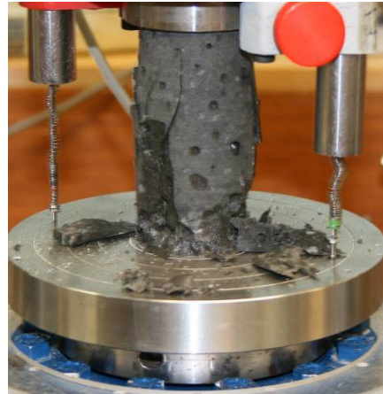
Nr. 2: Tholeiite (vesicular) \sigma_c = 94,2 MPa.
