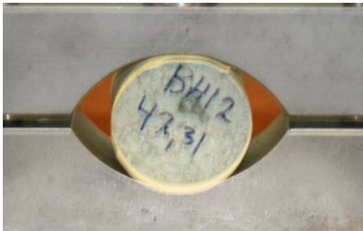
Nr. 78: Rhyolite (inhomogeneous) \sigma_t = 1,01 MPa.
