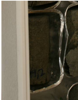
Nr. 7: Altered olivine tholeiite \sigma_c = 48,2 MPa.
