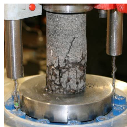
Nr. 6: Altered olivine tholeiite \sigma_c = 29,3 MPa.
