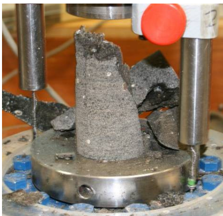
Nr. 5: Altered olivine tholeiite \sigma_c = 55,5 MPa.
