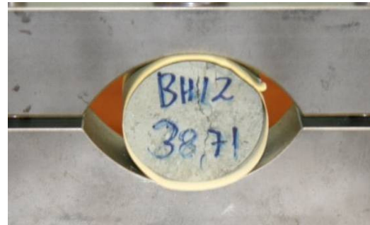
Nr. 75: Rhyolite (inhomogeneous) \sigma_t = 1,63 MPa.
