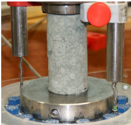
Nr. 25: Rhyolite (inhomogeneous) \sigma_c = 16,8 MPa.
