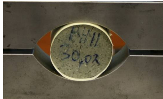
Nr. 83: Rhyolite (homogeneous) \sigma_t = 4,55 MPa.
