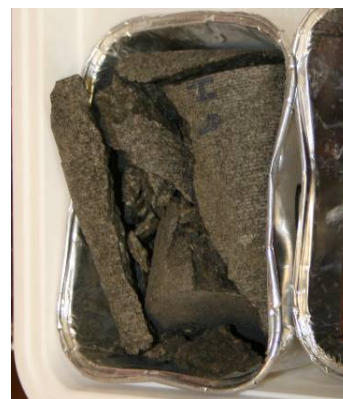
Nr. 13: Altered olivine tholeiite \sigma_c = 80,7 MPa.
