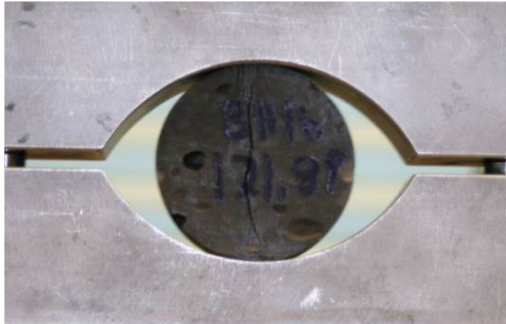
Nr. 42: Tholeiite (vesicular) \sigma_t = 8,51 MPa.
