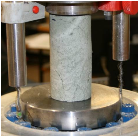
Nr. 31: Rhyolite (inhomogeneous) \sigma_c = 8,9 MPa.
