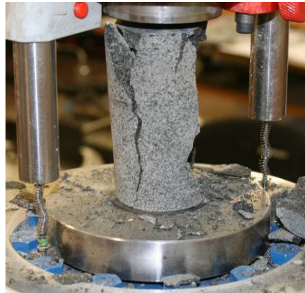
Nr. 9: Altered olivine tholeiite \sigma_c = 91,4 MPa.
