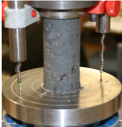
Nr. 1: Tholeiite (vesicular) \sigma_c = 89,4 MPa.
