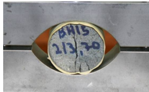
Nr. 47: Altered olivine tholeiite \sigma_t = 7,10 MPa.
