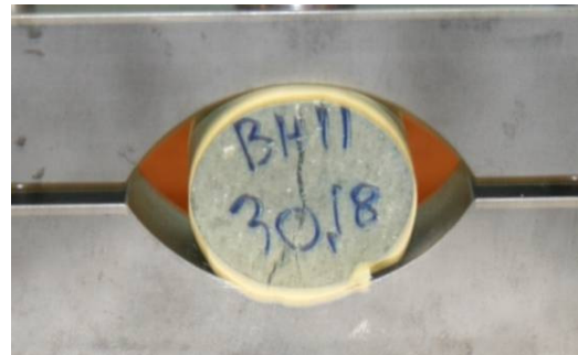
Nr. 85: Rhyolite (homogeneous) \sigma_t = 3,92 MPa.
