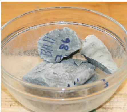
Nr. 34: Rhyolite (homogeneous) \sigma_c = 116,2 MPa.
