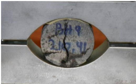
Nr. 52: Altered olivine tholeiite \sigma_t = 3,60 MPa.
