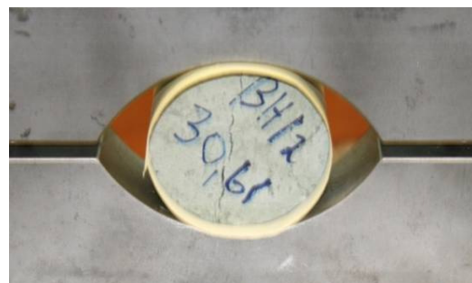
Nr. 73: Rhyolite (inhomogeneous) \sigma_t = 2,31 MPa.
