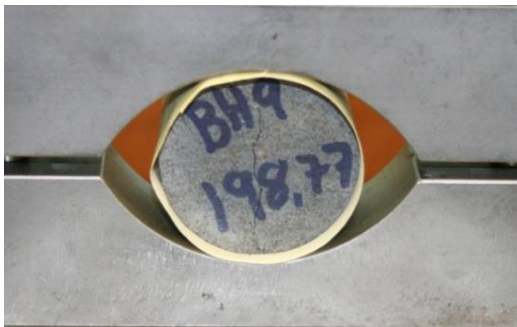
Nr. 68: Altered olivine tholeiite \sigma_t = 5,18 MPa.
