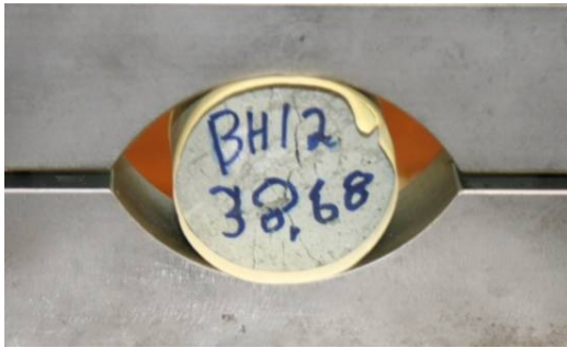
Nr. 74: Rhyolite (inhomogeneous) \sigma_t = 3,06 MPa.
