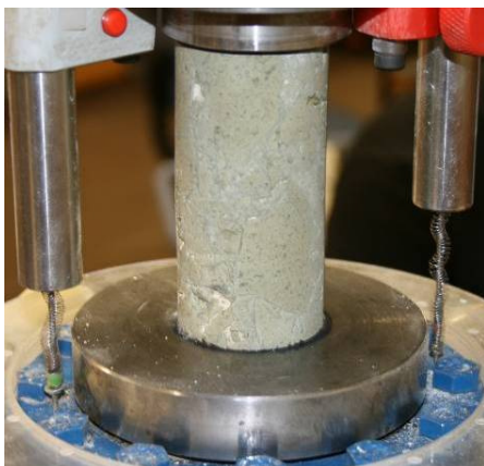
Nr. 27: Rhyolite (inhomogeneous) \sigma_c = 7,1 MPa.
