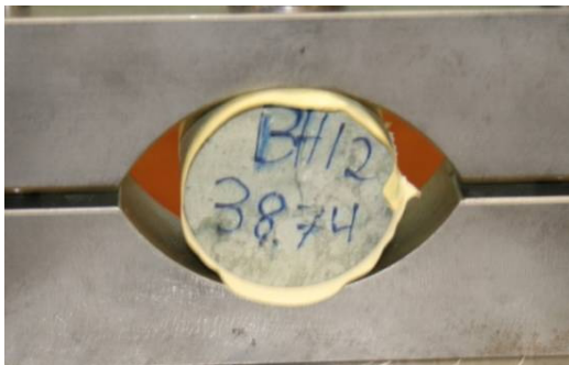
Nr. 76: Rhyolite (inhomogeneous) \sigma_t = 3,66 MPa.
