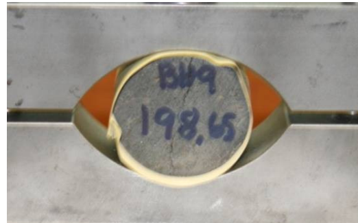
Nr. 67: Altered olivine tholeiite \sigma_t = 5,38 MPa.
