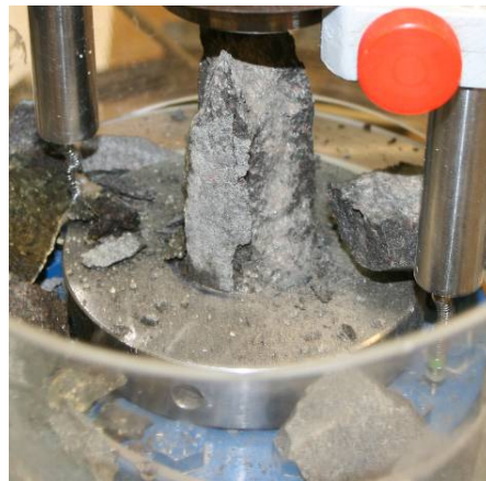
Nr. 4: Altered olivine tholeiite \sigma_c = 79,3 MPa.
