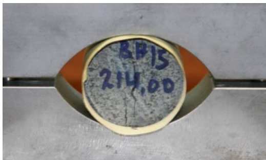
Nr. 48: Altered olivine tholeiite \sigma_t = 7,10 MPa.
