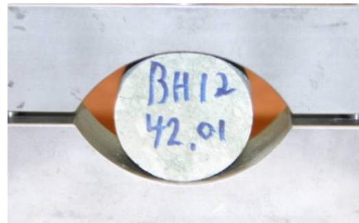
Nr. 77: Rhyolite (inhomogeneous) \sigma_t = 2,16 MPa.
