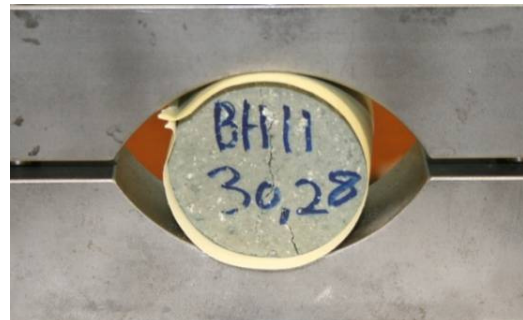
Nr. 87: Rhyolite (homogeneous) \sigma_t = 2,61 MPa.
