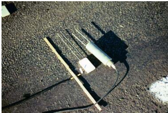
M5 Rakamælar (TDR). Vinstri neminn (hvítur) frá Campell Sci. og sá hægramegin (grár) frá IMKO GmbH.
