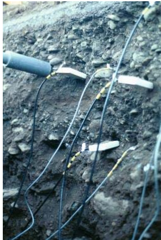
M10 Nærmynd af mælum. sjá má báðar gerðir af rakamælum og hitanema. .
