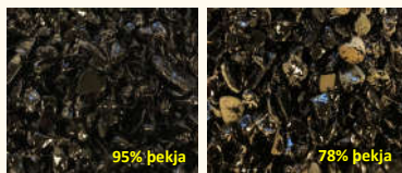
Mynd 2. Niðurstöður viðloðunarprófs á steinefni ætlað í klæðingu. Báðar myndir eru af efni úr Grímsá en notað var sitt hvort viðloðunarefnið. Almennu eru kröfur fyrir viðloðun á bilinu 90% - 99%, háð umferðarþunga.
