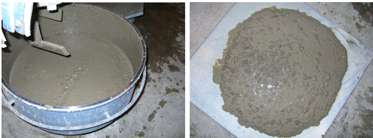
Mynd 16: Stöðugleikaástand steypu í blandara (til vinstri) og á sigmálsborði (til hægri).
