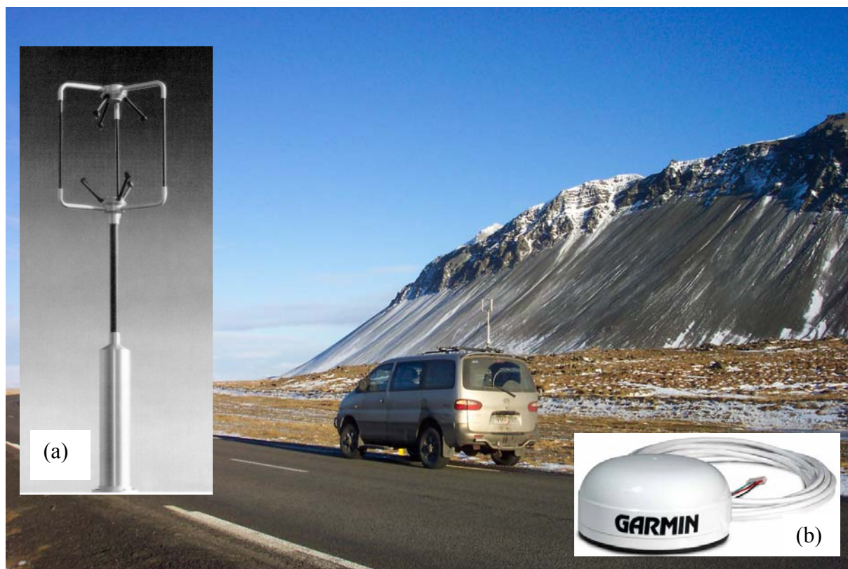
Mynd 39. Færanlegt vindmælitæki við Hafnarfjall. (a) Innfelda myndin sýnir úthljóðsvindhraðamæli (ultrasonic anemometer) frá Gill instruments sem mælir vindvektor í láréttu plani og lóðréttan vindhraða. (b) Innfelda myndin sýnir 12 rása GPS mælitæki frá Garmin til skráningar á staðsetningu, hraða og stefnu.
