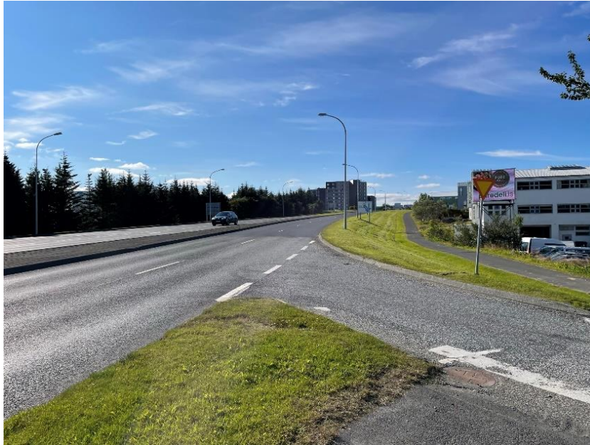
Mynd 20: Óskýr yfirborðsmerking, Vesturlandsvegur-Höfðabakki.
