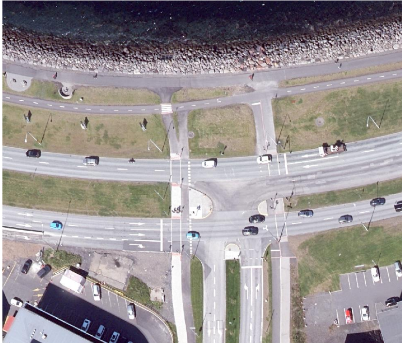
Mynd 8: Dæmi um gatnamót þar sem hægri beygju framhjálaupi hefur verið breytt yfir í sérakrein á ljósum. Gatnamót Sæbrautar og Katrínartúns í Reykjavík.
