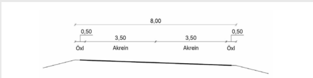
↑ Mynd 4.1 Þversnið vegtegundar C a .
