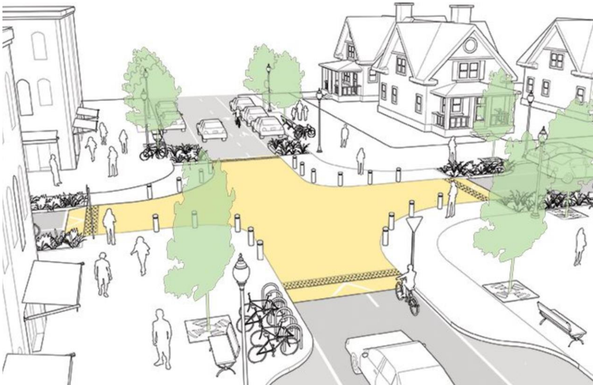
MYND 5 Dæmi um upphækkuð gatnamót. Allir leggir gatnamótanna eru hækkaðir upp og byrjar allt að 10 m fyrir gatnamótin sjálf (NACTO, 2021).
