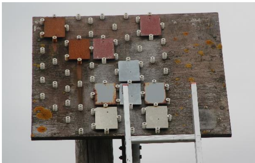
MYND 2 Tæringarsýni á Höfn í Hornafirði. Stálsýni efst til hægri. Sínksýni fyrir miðju og álsýni neðst. Önnur sýni eru máluð.
