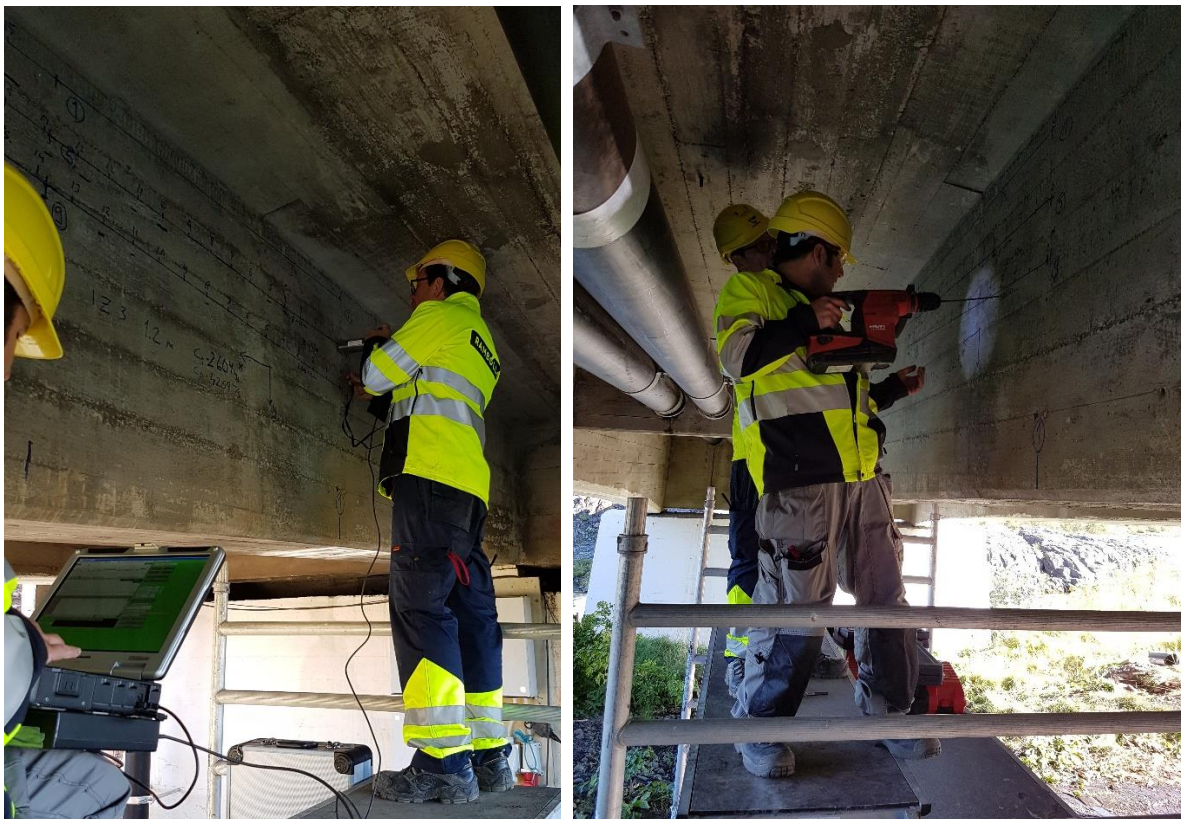
MYND 14 Höggbylgjuaðferð notuð til að skoða betur galla í grautun. Hægra megin er borað inn að kapli þar sem líkur eru á galla.
