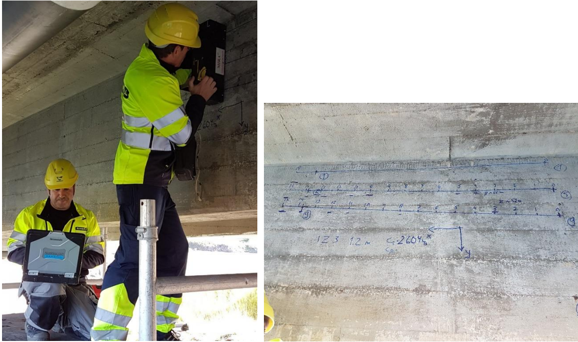
MYND 13 Endurkastsmæling (Ultrasound 3D) á spenniköplum. Hægra megin er sýnt mynstur mælinganna.
