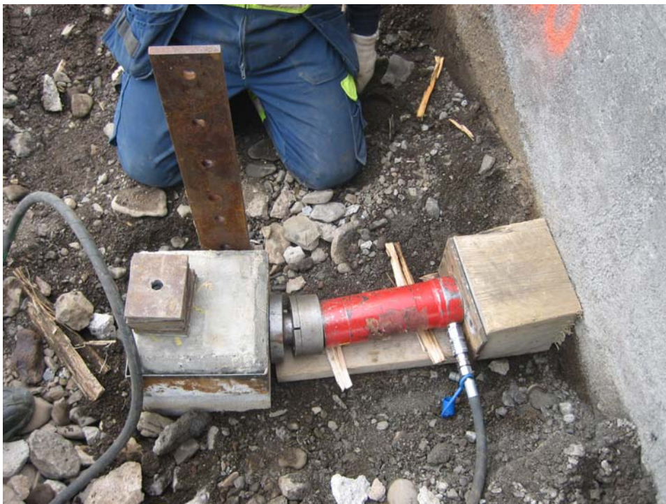
Mynd 20. Staur 1 prófaður. Sjá má hvernig gamli landstöpullinn var notaður sem viðspyrna.
