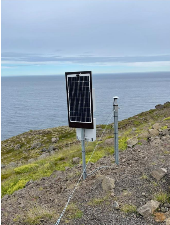
Mynd 2: (a, til vinstri) Uppsetning mælitækja. Sólarsella vísar að myndavél, tækjabúnaður og rafgeymar eru í kössum bakvið sólarselluna. GNSS loftnetið er á sér staur til hægri á ljósmyndinni. (b, til hægri) Færslur á stöðvunum ALM5 og ALM4 í Tjarnardalaberghlaupinu. Stöðvarnar færast til ANA, og hefur stöðin ALM5 færst um 50 cm síðan mælingar hófust í Ágúst 2022. Lóðréttar færslur (neðst á mynd til hægri) eru alla jöfnu mun minni en lóðréttar fræslur.
