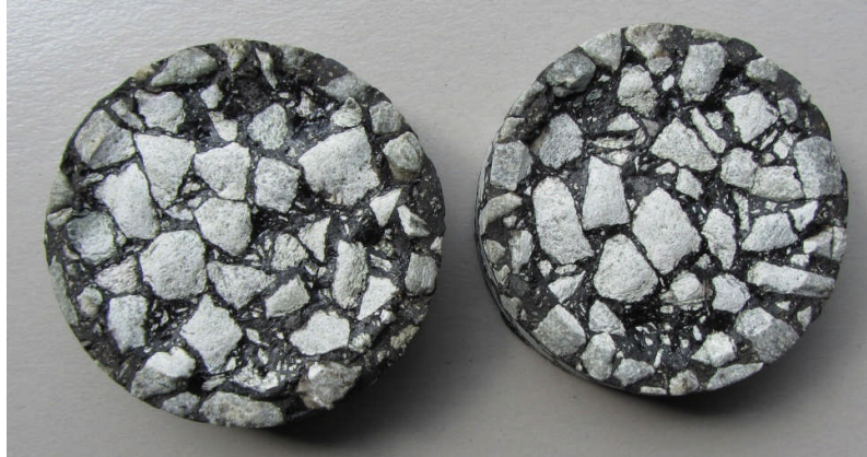
Mynd 2.4. Sneiðar af borkjörnum úr SMA 16 sem var lagt á Hringbraut 2001. Myndirnar eru teknar eftir Prallprófun og af þeirri hlið sem prófuð var.
