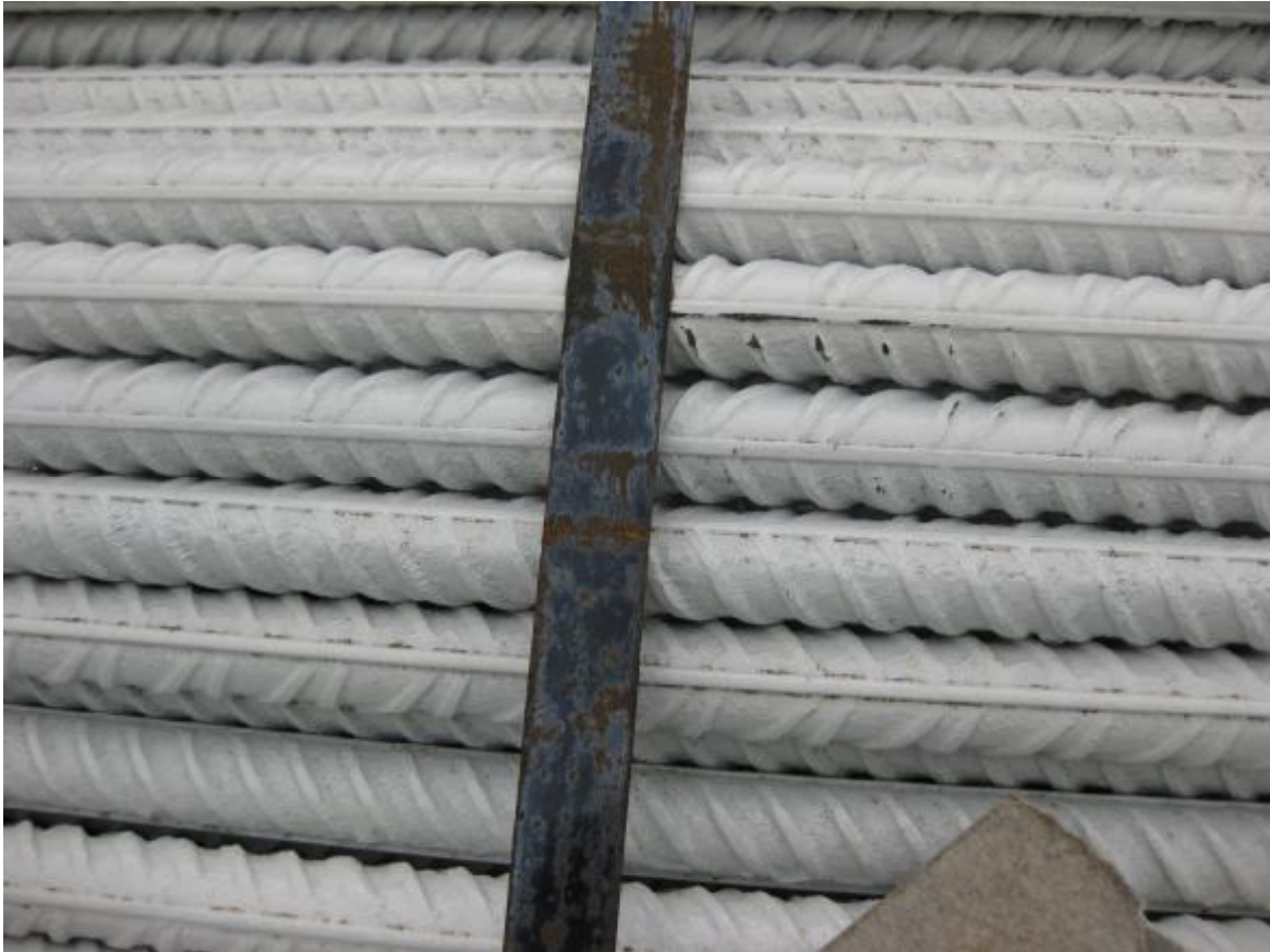
Mynd 4. Járngjörð hefur nuddast við „combi-coat“ bolta og rispað af epoxy húðina.
