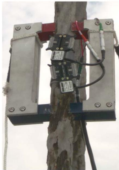
Mynd 4-1 Búnaður sem komið er fyrir til að senda hljóðbylgjur eftir strengum (CableScan frá PureTechnologies).
