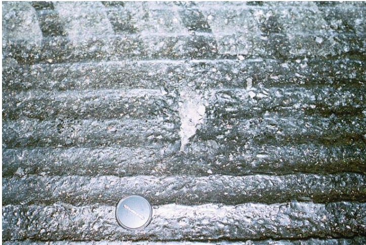
Mynd 4-17 IS02, markar fyrir förum eftir álagshjól, einnig er hola að byrja að myndast
