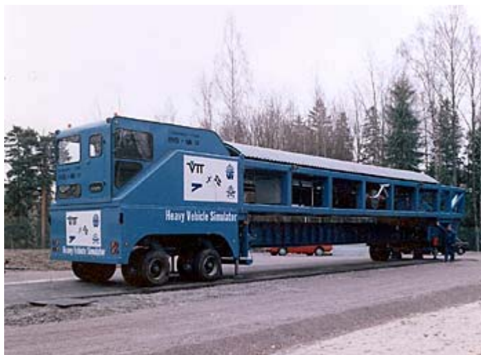
Mynd 1-1 HVS-tæki sem Svíar og Finnar eiga í sameiningu.
