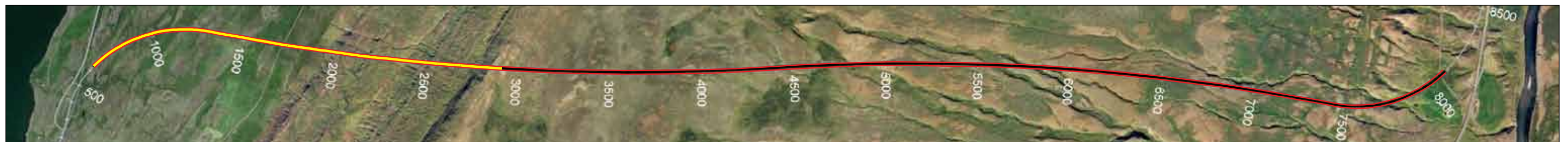
Vaðlaheiðargöng, staða framkvæmda 5. maí 2014. Búið er að sprengja 2.289 m frá Eyjafirði sem er 32% af heildarlengd.
