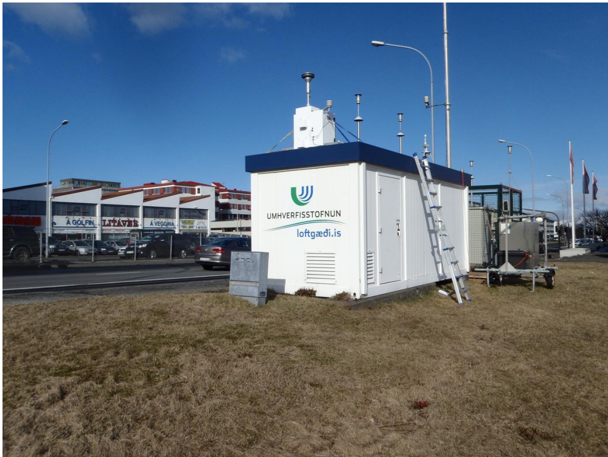
Mynd 5 Sýnataki staðsettur uppi á þaki loftgæðastöðvar við gatnamót Grensásvegur og Miklubrautar.
