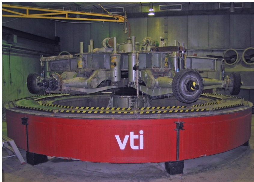
Mynd 7-3 Veghermir Sænsku Vegtæknistofnunarinnar [mynd VTI].
